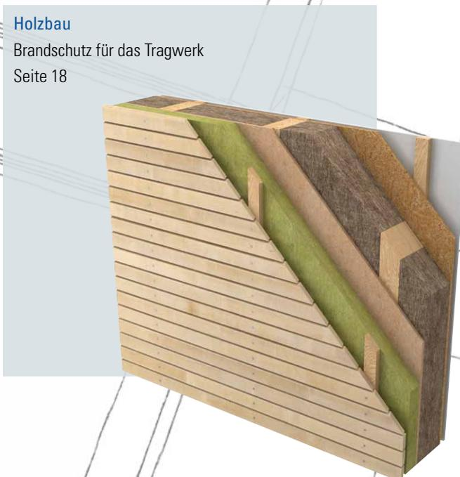
Steinwolle von Flumroc ist aufgrund ihrer speziellen Gesteinsmischung äusserst hitzebeständig und dank ihrem Schmelzpunkt von über 1000 Grad Celsius auch bei hohen Brandtemperaturen sicher. Deshalb eignen sich Dämmmaterialien aus Steinwolle von Flumroc überall in Gebäuden für den Einsatz als Brandschutz – beispielsweise an der Fassade, in Holzkonstruktionen oder bei Bauteilen aus Stahl.
