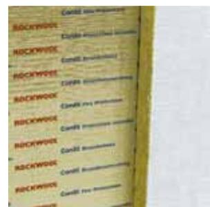
Faccia anteriore rinforzata con velo vetro bianco, retro rinforzato con un foglio di alluminio codificato cromaticamente e con rete metallica. Realizzazione di sistemi tagliafuoco flessibili privi di rivestimento per attraversamenti antincendio combinati per tubi e fasci di cavi S30-S90.
