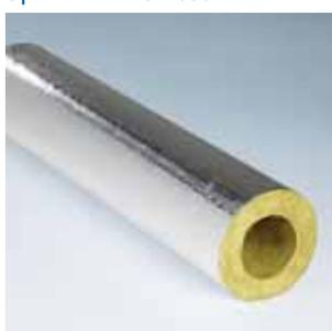
Coppella indeformabile avvolta con fibre a disposizione concentrica, rivestita in alluminio, ad alto valore isolante con un basso spessore isolante. Indicata per le canne fumarie di metallo in conformità delle disposizioni dell'AICAA.
