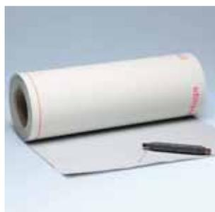
Per coibentazioni antincendio di fasci di cavi elettrici fino a 100 mm di diametro per ogni tipo di cavi posti in opera in pareti massicce o pareti divisorie con orditura metallica > 100 mm di spessore, nei solai massicci > 150 mm di spessore e nel pannello di penetrazione Conlit®.
