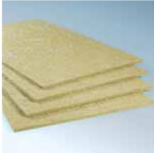
Pannello isolante indeformabile e resistente alla compressione. Rivestimento antincendio di travi portanti e travetti in acciaio per una resistenza al fuoco di 30–180 minuti, rispettivamente di 30–120 minuti nel caso di puntelli in acciaio.
