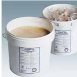
Adesivo a base di caolino e silicato di sodio, puramente inorganico, non combustibile A1. Lavorabile con temperature superiori a ca. +5°C (Conlit Fix) o -7°C (Conlit Fix Cold). Per incollare i giunti dei pannelli Conlit e delle coppelle Conlit.
