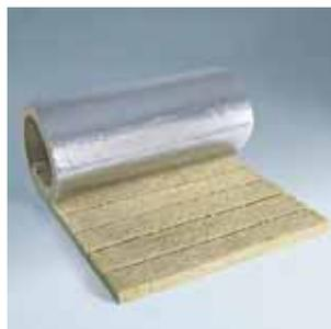
Materasso a lamelle con rivestimento in alluminio su un lato, per il rivestimento di canali e tubi di ventilazione, condutture e serbatoi di vario genere con temperature dei fluidi  $\leq 250^\circ\text{C}$ .
